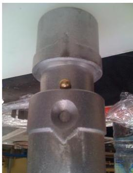
Die richtige Positionierung beim Einstecken des Profils sehen Sie anhand einer Einkerbung an beiden Profilen die übereinstimmen sollte ! Wenn Sie nach dieser Markierung einschieben, rastet der Druckbolzen automatisch ein – sollte dies nicht der Fall sein, bitte das Profilrohr ein wenig nach links oder rechts drehen bis der Druckbolzen dann einrastet.
